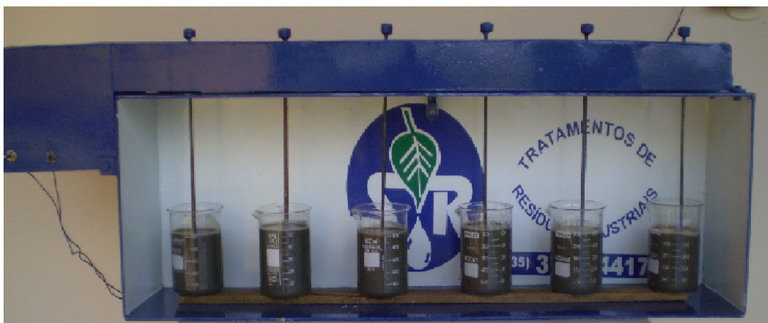
Figura 3: Jar Test utilizado para análises de floculação e coagulação de água residuária de suinocultura.
