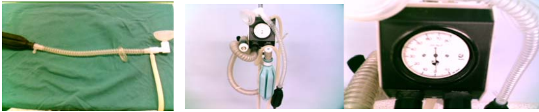
Figura 12- Sistema ventilatório utilizado para teste da hiperpressão
