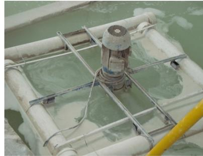
FIGURA 11: bombeamento para recirculação
