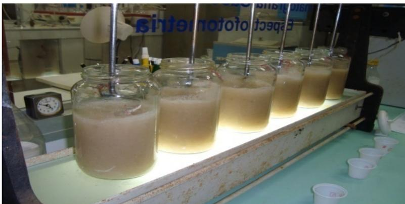
FIGURA 7- Jarro Teste com o efluente líquido e sementes de moringa trituradas
