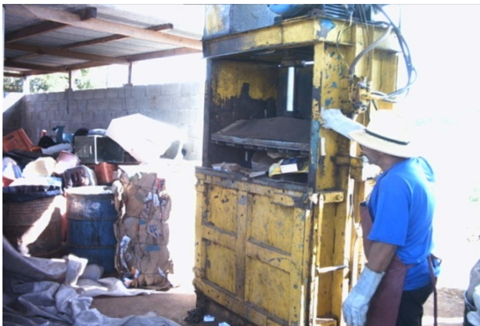
Figura 5 – Atuação de trabalhadores na prensagem de fardos de materiais recicláveis
