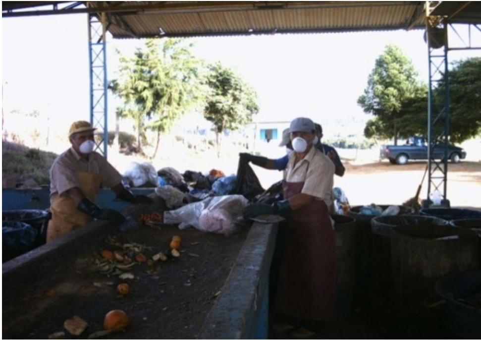
Figura 4 – Atuação de trabalhadores na mesa de triagem. Visualização dos tambores de separação dos materiais recicláveis ao redor da mesa de triagem.
