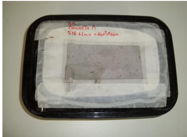
Figura1: Bandeja vedada com a utilização de voile (tratamento A)
