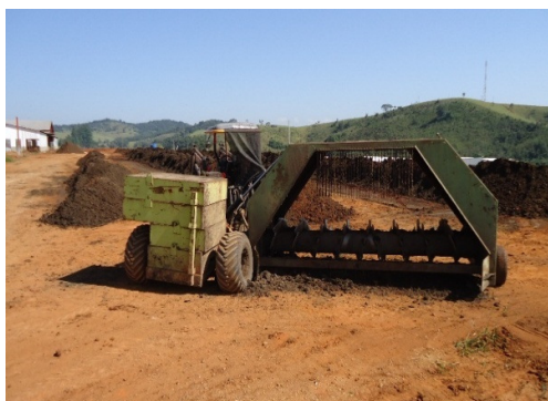
FIGURA 18 – Composteira utilizada no revolvimento das leiras de compostagem.
