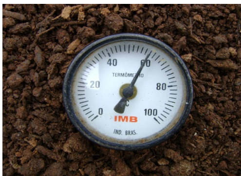
FIGURA 20 – Leitura da temperatura na leira de compostagem com termômetro analógico.
