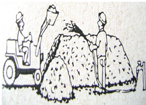
FIGURA 5 – Distribuição uniforme de água na massa de compostagem para reposição da umidade perdida. Fonte: Pereira Neto (2007).
