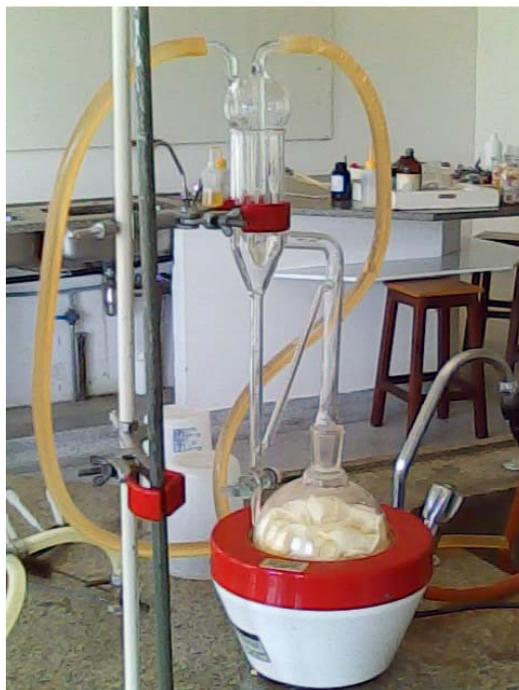
**FIGURA 13** - Aparelho de Clevenger para extração de óleo essencial.
