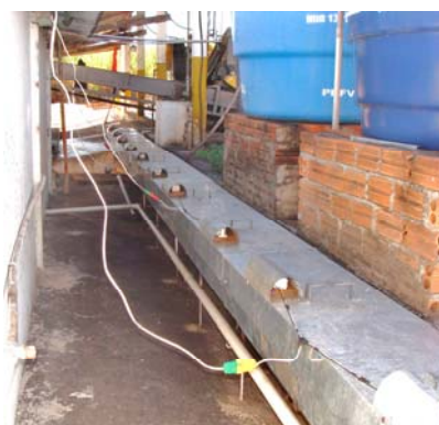
FIGURA 5 – Ilustração da câmara de desinfecção para tratamento do caldo de cana.
