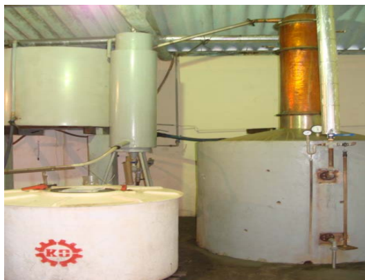
FIGURA 10 - Ilustração do aparelho destilador (alambique).
